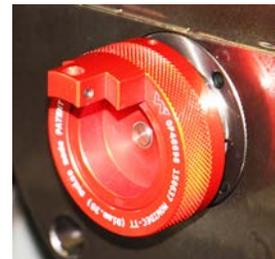
Nun montieren Sie den Sensor (Detektor) in die Aufnahmebohrung des Sensorringes und verbinden Sie den Sensor (Detektor) mit dem Gerät.
