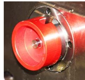
Montieren Sie anschließend den passenden Sensorring auf den Adapter und befestigen Sie ihn mit seiner Klemmschraube.
