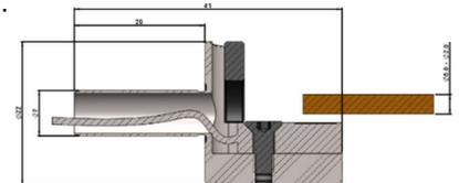
Modèle Horlogerie Mowi-TS-5 queue Ø 5.0 mm (encombrement réduit)
