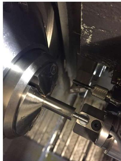
Sur les supports multiples, chaque position d'outil peut être centrée sans besoin de démonter les outils voisins du poste d'usinage. L'ajustement des porte-outils réglables est grandement facilité.
