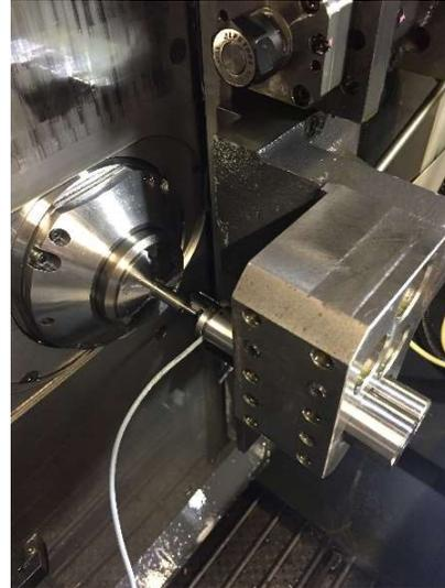
Möglichkeit, Spindeln oder „Schwanenhäulse“ gegenüber Führungsbüchse zu zentrieren
